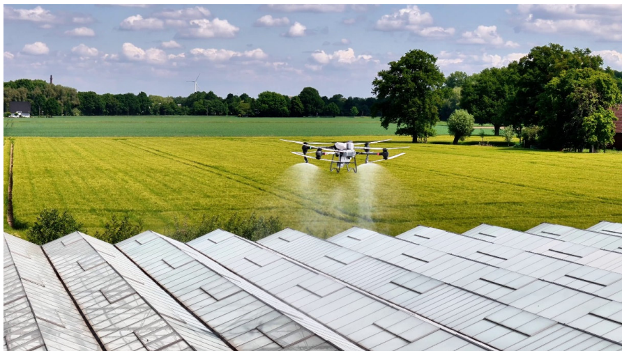
Die Agrardrohne im Einsatz: Hier schattiert die Drohne ein Gewächshaus am Niederrhein. Foto: Drohnen Agrar Service
